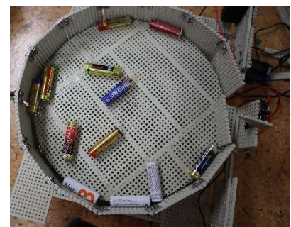
図3 円盤の回転で向きを整える
