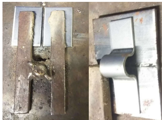
図 4 抗折試験片製作時（左）とハンドル溶接時
